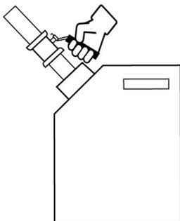
※ 給油缶は、90° 開閉式のバルブをホース途中に設け燃料漏出時に即時対応出来るよう対策することを推奨します。それ以外は、市販時の形状、容量を保持して下さい。
